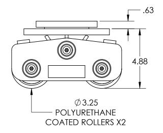
Model Number » CS-25-P Capacity » 10 Tons Each Length » 9" Width » 12" Height » 5.5" Weight » 39 lbs Paint » Hevi-Haul Red
