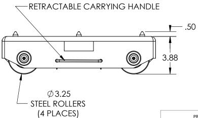
Model Number » X-30 Capacity » 15 Tons Each Length » 15.75" Width » 10.50" Height » 3.875" Weight » 63 lbs Paint » Hevi-Haul Red
