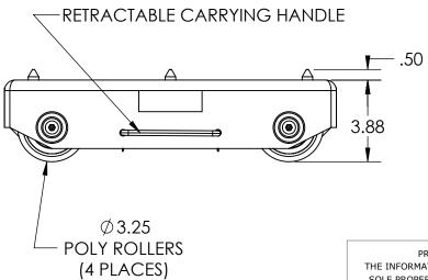
Model Number » X-30-P Capacity » 15 Tons Each Length » 15.75" Width » 10.50" Height » 3.875" Weight » 51 lbs Paint » Hevi-Haul Red
