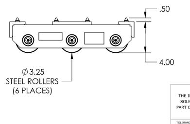
Model Number » ST-1060 Capacity » 30 Tons Each Length » 16" Width » 11.75" Height » 4" Weight » 104 lbs Paint » Hevi-Haul Red
