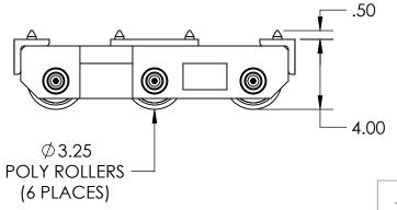
Model Number » ST-1060-P Capacity » 30 Tons Each Length » 16" Width » 11.75" Height » 4" Weight » 86 lbs Paint » Hevi-Haul Red
