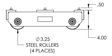
Model Number » ST-1040 Capacity » 20 Tons Each Length » 16" Width » 11.75" Height » 4" Weight » 81 lbs Paint » Hevi-Haul Red
