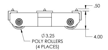
Model Number » ST-1040-P Capacity » 20 Tons Each Length » 16" Width » 11.75" Height » 4" Weight » 69 lbs Paint » Hevi-Haul Red
