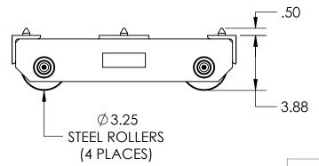
Model Number » ST-1012 Capacity » 6 Tons Each Length » 15.75" Width » 10.50" Height » 3.875" Weight » 58 lbs Paint » Hevi-Haul Red
