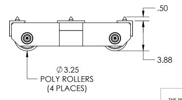
Model Number » ST-1012-P Capacity » 6 Tons Each Length » 15.75" Width » 10.50" Height » 3.875" Weight » 46 lbs Paint » Hevi-Haul Red
