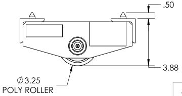
Model Number » JD-3-P Capacity » 1.5 Tons Each Length » 9.50" Width » 6" Height » 3.875" Weight » 12 lbs Paint » Hevi-Haul Red
