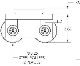
Model Number » CS-5 Capacity » 2.5 Tons Each Length » 8.125" Width » 6" Height » 4.5" Weight » 30 lbs Paint » Hevi-Haul Red
