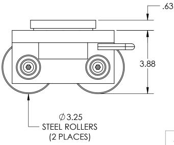
Model Number » CS-3 Capacity » 1.5 Tons Each Length » 8.125" Width » 6" Height » 4.5" Weight » 30 lbs Paint » Hevi-Haul Red
