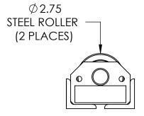
Model Number » BR-2 Capacity » 6 Tons Each Length » 9.5" Width » 4" Height » 3.25" Weight » 20 lbs Paint » Hevi-Haul Red
