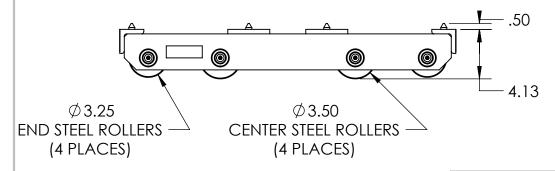
Model Number: BB-100 Capacity » 50 Tons Each Length » 28" Width » 12" Height » 4.125" Weight » 150 lbs Paint » Hevi-Haul Red
